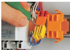
Remoção de um suporte de montagem do conjunto.
