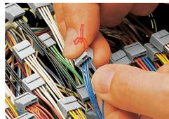
Remoção: Segure o condutor a ser removido e torça-o para a esquerda e direita enquanto puxa o conector.
